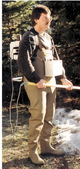
Hierzu wird ein Batteriegerät oder ein Gerät mit Benzinmotor verwendet, das der Elektrofischer auf dem Rücken trägt. Als Anode dient ein elektrifizierter Fangkescher mit isoliertem Kescherstiel. Der Totmannschalter ist hierbei am günstigsten im hinteren Teil des Kescherstiels eingebaut. Die Kathode ist am Besten als Kupferseil mit ca. 16 qmm Querschnitt ausgelegt. Die Länge sollte mindestens 2 Meter betragen.
